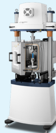
Рисунок 1. Аналізатор з навантажувальною рамою ElectroForce 3330 з піччю та оснасткою для випробування на розтяг
