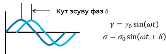
Рисунок 1. Ілюстрація динамічних коливальних випробувань в режимі зсуву
