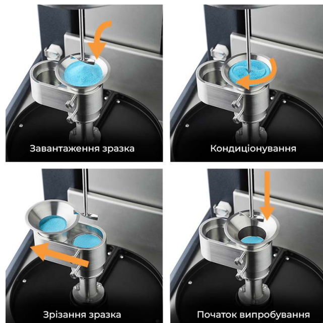
Рисунок 2. Процес завантаження і випробування зразків за допомогою аксесуара для реології порошку
