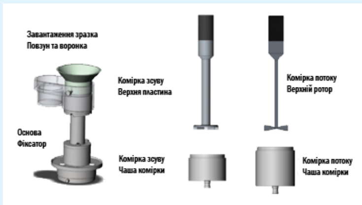
Рисунок 1. Набір аксесуарів для порошкової реології TA Instruments зі змінними пристосуваннями для комірок зсуву і потоку
